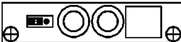
Рисунок 8-Положение переключателя для режима “HART модем”
