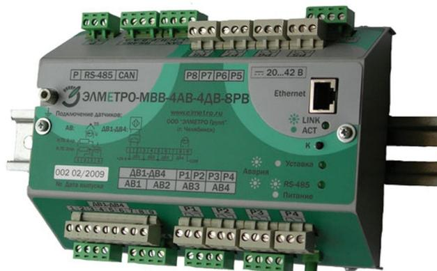
Модули ввода-вывода из семейства ЭЛМЕТРО-MBB являются компонентами распределенной системы сбора данных и управления. Модули могут соединяться как между собой, так и с внешней системой управления. В сочетании с большим выбором доступных конфигураций это дает возможности построения высокоэффективных и недорогих систем управления производственными процессами, в т. ч. и распределенных.
