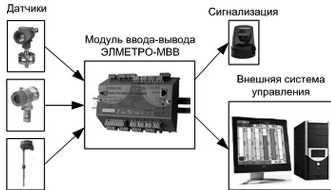
Распределенная система сбора данных. Модули ввода-вывода собирают данные с различных датчиков, преобразуют и передают по различным интерфейсам на верхний уровень АСУТП (контроллер АСУТП, локальная сеть предприятия, автоматизи-
