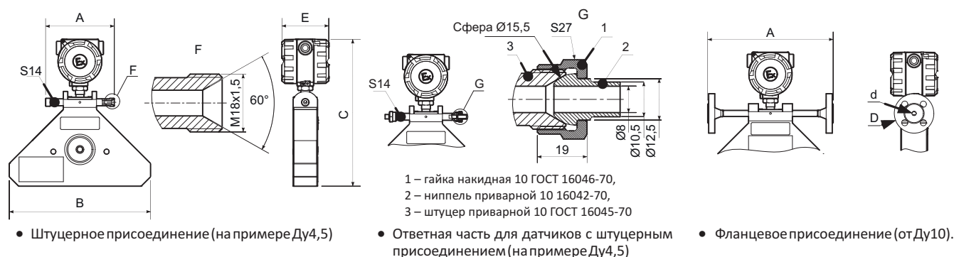
⇒ Рис. 8. Габариты и присоединительные размеры датчиков Ду4,5; 10; 15
